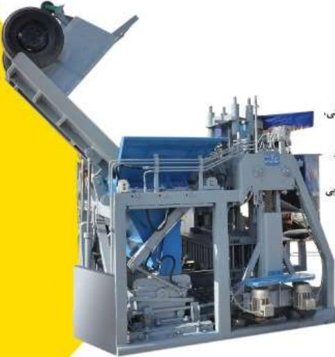
کاربرد ▶ جهت تولید انواع بلوک دیواری، سقفی و تیغه ای به اشکال مختلف
